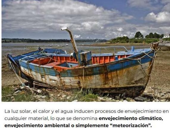
Los cambios químicos y físicos irreversibles aparecen primero a nivel microscópico y se acumulan con el tiempo formando cambios macroscópicos no deseados, p. decoloración, coloración amarillenta, descamación o pérdida de resistencia a la tracción.
